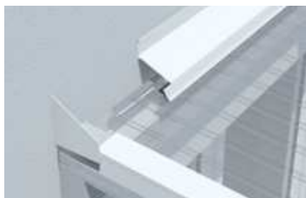
5 Wandanschlussprofil Mit zusätzlichen Seitenblenden ist der Anschluss zur Hauswand gesichert. Die Fuge ist mit Plexisil abzudichten.
