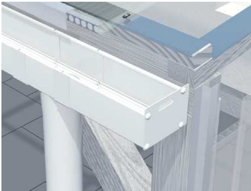
7 Dachrinnen Für die zuverlässige Entwässerung hochwertiger Überdachungen bis 51 qm Grundfläche. Die runde owolux® aus Hart-PVC oder die eckige alwo® aus Aluminium. Beide überzeugend in Qualität und Funktion. Die owolux® Dachrinne ist für freie Spannweiten bis max. 600 mm von Sparren zu Sparren geeignet. Für größere Spannweiten sollte die alwo® Dachrinne genutzt werden, hier sind Spannweiten bis 1.250 mm möglich.
